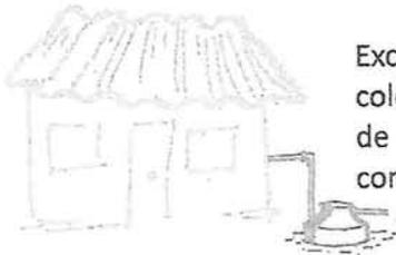
Excavación manual de 0.40m para colocación de tinaco con capacidad de 2,500 lt, cuenta con plantilla de concreto f'150 kg/cm2
